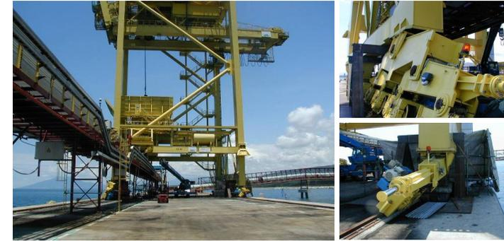
Grúa para descarga de barco 850T y transportador dañado por la colisión de un buque en el Este de Java, Indonesia.
