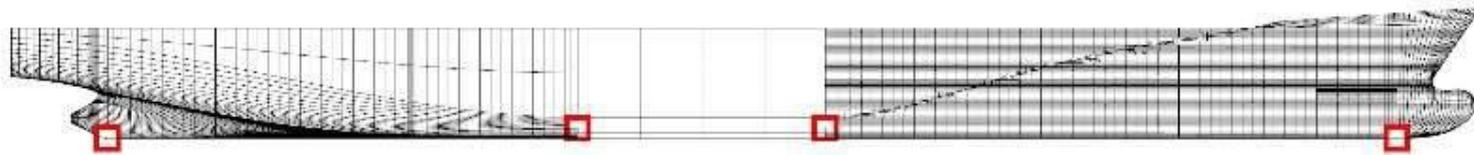
**6 puntos de medición para el UKC**
