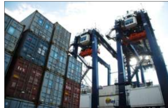
EQUIPOS ESPECIALIZADOS 4 GRÚAS RTG
